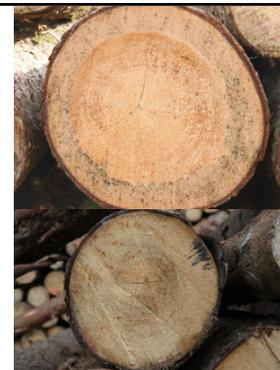
**Rindenabzugswerte:** Bei der manuellen Vermessung von Stammholz in Rinde sind angemessene Rindenabzüge vorzunehmen, die im Regelfall in automatisierter Form erfolgen. Für die Holzarten **Fichte** und **Tanne**, deren Rindenstärken in relativ geringen Grenzen schwankt, sind nachfolgende, **wissenschaftlich hergeleitete Rindenabzüge zu empfehlen.**
